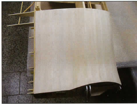
Obr. 19 - Potah křídla z balzy 3 mm
