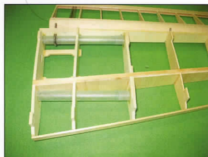
Obr. 31 - Uložení VOP na trupu je pomocí duralových trubek o průměru 18 mm
