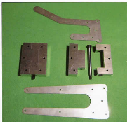
Obr. 4 - Kování pro uchycení konce křídla na centroplán – poslední model bez sklápění křídla
