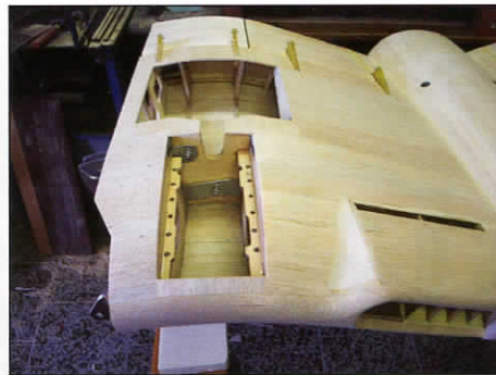
Obr. 3 - Lože podvozků, podvozek je uchycen osmi imbus šrouby M5
