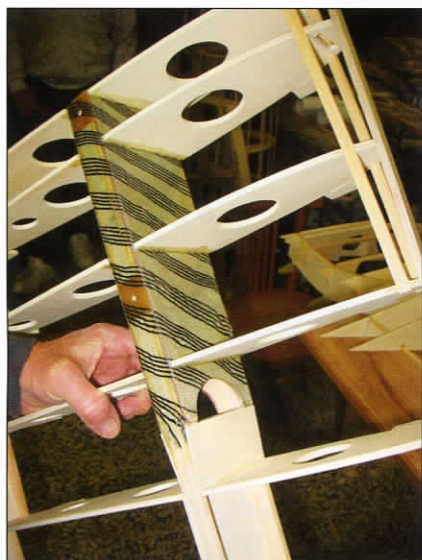
Obr. 13 - Olamínování kapsy, ve které je vložen mechanismus pro sklápění křídla
