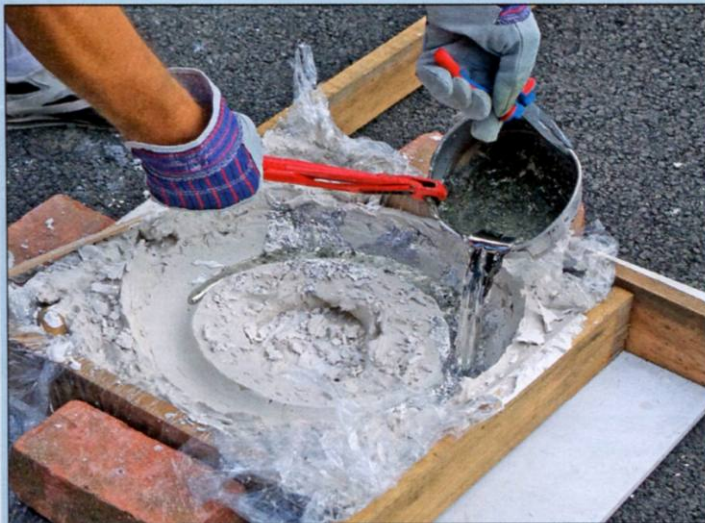
Odlévání 4 kg závaží z roztaveného oloveného plechu pro dovážení modelu v polních podmínkách
