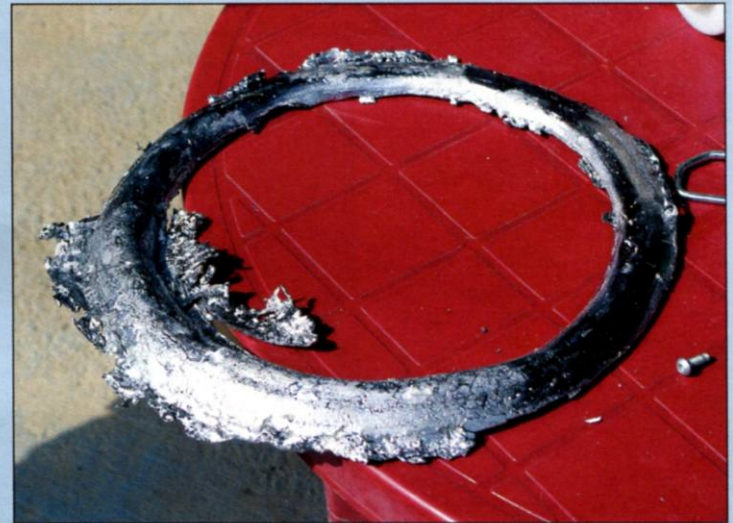
Odlévání 4 kg závaží z roztaveného oloveného plechu pro dovážení modelu v polních podmínkách
